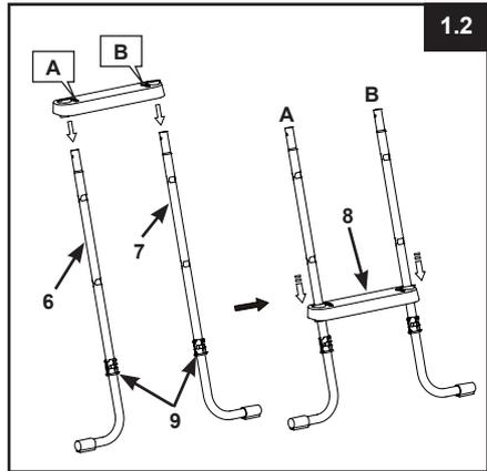
**IMPORTANTE:** Assegure-se de que as pernas com formato em J estejam viradas para fora antes de instalar os degraus.
